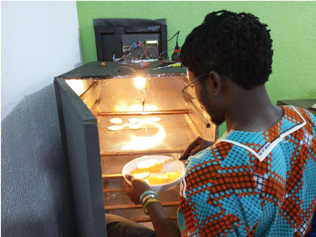
*Dans le dispositif, vous avez la possibilité de mettre une ampoule chauffante pour créer les conditions thermiques nécessaires à déshydrater le fruit.*
