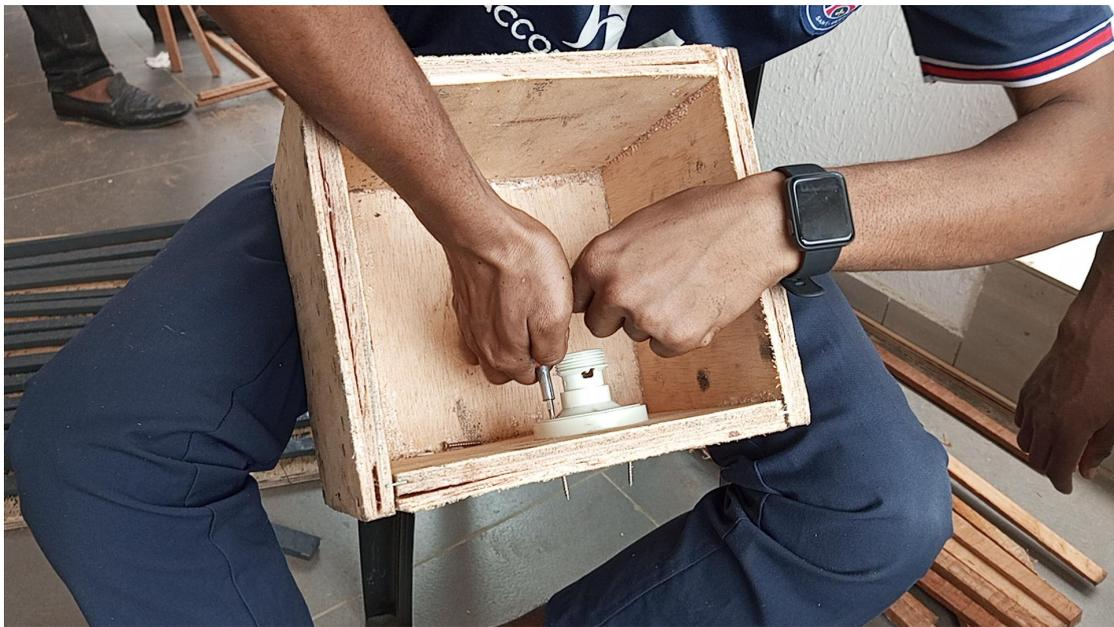
Ce boîtier nous permet d'installer les composants électroniques qui auront pour fonction de contrôler le chauffage, la température selon le besoin des fruits à déshydrater.
