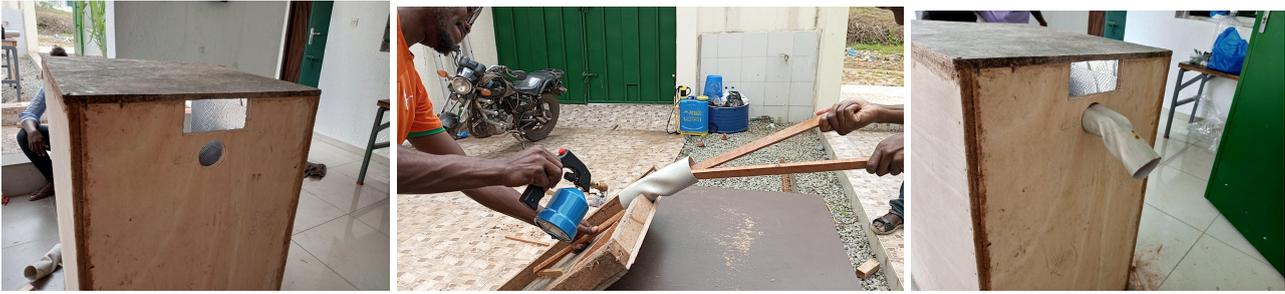
\* Assurez-vous de créer deux ouvertures à l'arrière du dispositif. La première ( Carré servira pour assembler la boîte où se trouve l'électronique) . La seconde est pour le tuyau qui sera connecté à la cheminée. Vous pouvez réchauffer le tuya pour avoir une forme courbée et adaptée à votre dispositif de cheminée.
