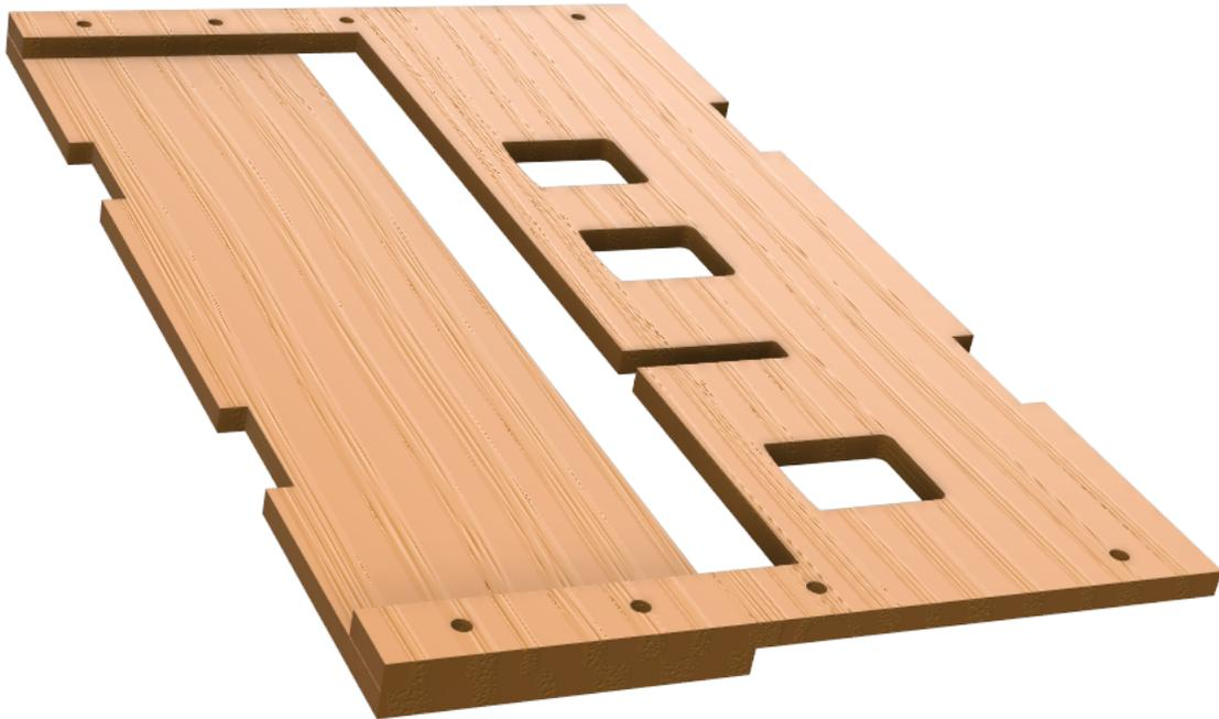
**Attention :** les 2 pièces doivent être parfaitement alignées. Placer des vis dans les percages pour bien aligner les pièces. Il ne doit pas y avoir d'espace entre les deux pièces (ou la feuille de papier pourrait venir se coincer). Bien serrer les pièces l'une contre l'autre avec des pinces de serrages
