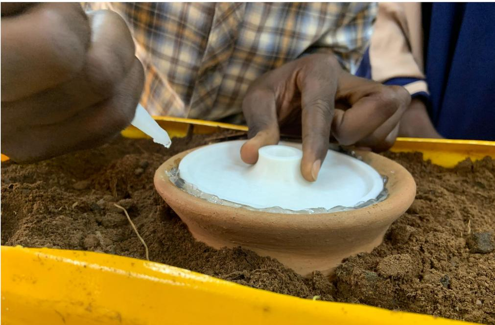
Ensuite on pose le couvercle et on met par-dessus du silicone entre le bord du couvercle et le pot.
