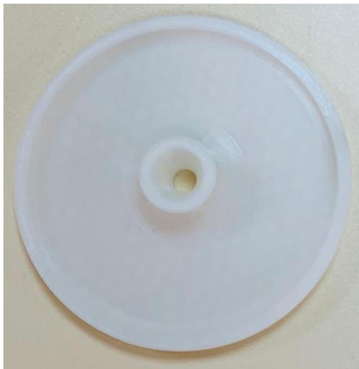
Avant l'atelier des couvercles ont été imprimés pour gagner en temps vu que l'impression d'une seule couvercle prend environ 3h de temps . Il faut donc 12h de temps pour l'impression des 4 couvercles .
